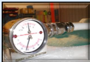
Специальный датчик контроля температуры и давления воды, поступающей через ручной шланг
